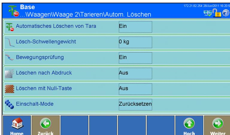
**Abbildung 3-50: Konfigurationsbildschirm Automatisches Löschen von Tara**
