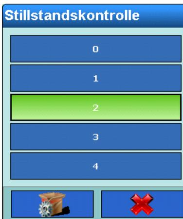
**Abbildung 3-61: Automatische Stillstandskontrolle für SICS- und IDNet-Waagen**
