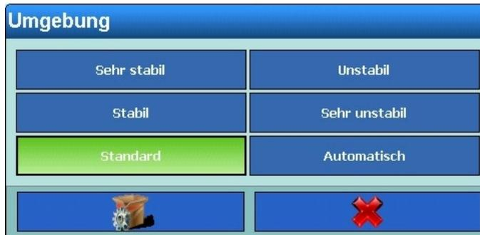
**Abbildung 3-62: Einstellungsdialog Umgebung der Stillstandskontrolle – Analogwaagen**
