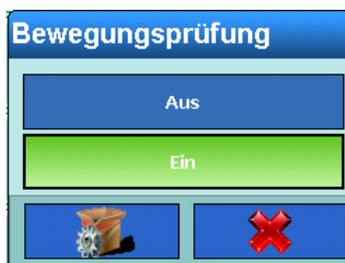
**Abbildung 3-52: Einstellungsdialog Bewegungsprüfung bei automatischem Löschen von Tara**
