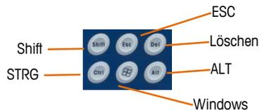
**Abbildung 1-10: IND970-15 Detailansicht der Windows-Funktionstasten**
