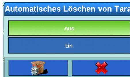
Abbildung 3-49: Einstellungsdialog Automatisches Löschen von Tara
