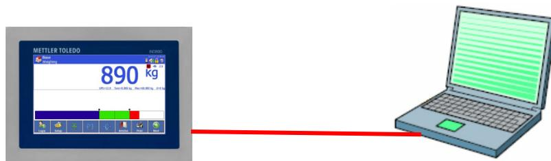
Abbildung B-1: Crossover-Kabelverbindung vom IND900 an einen PC
