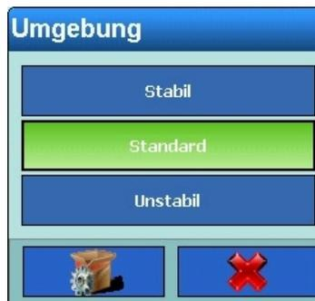
**Abbildung 3-63: Einstellungsdialog Umgebung der Stillstandskontrolle – IDNet- und SICS-Waagen**
